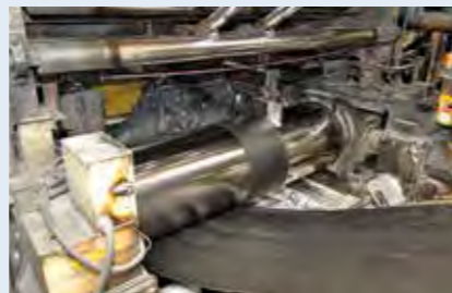
圧延 お客様の仕様に応じて、混ぜ合わせたゴムをシート状に圧延します。
