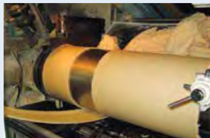
圧延 お客様の仕様に応じて、混ぜ合わせたゴムをシート状に圧延します。
